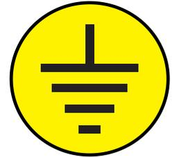
Der Ofen ist in ein Potenzialausgleichssystem einzubinden und mit einem Leiter mit einer Drahtstärke von mindestens 10 mm<sup>2</sup> zu verbinden, der an die Klemme an der Rückseite des Ofens mit dem entsprechenden Symbol anzuschließen.
